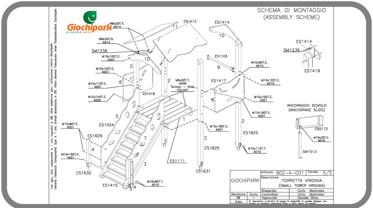
4. Dopo aver preparato le buche e terminato l'assemblaggio in prossimità delle stesse, l'attrezzo va fissato al terreno con cemento. Quando la "presa" del cemento è efficiente, il gioco è pronto per l'uso!
