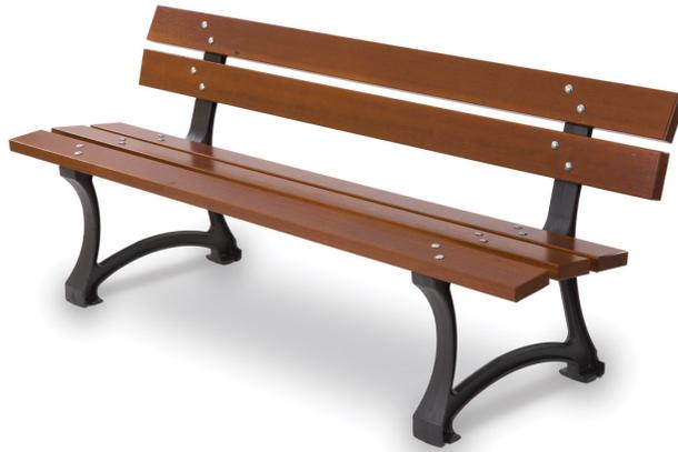
Panca con due supporti in ghisa, sei doghe in legno tropicale sez cm 11 x 3,3 e bulloneria in acciaio zincato. Trattamento del legno con protezione fungicida e idrorepellente. Supporti trattati con primer e verniciati a forno, muniti di attacchi per fissaggio al terreno.
