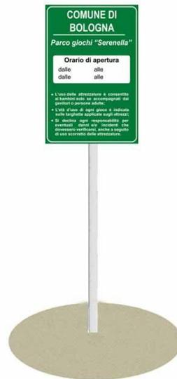
Cartello informativo costituito da un paletto in acciaio zincato Ø 60 mm da interrare e pannello in lamiera zincata dim. cm 60x90 h fissato al paletto con collari e bulloncini in acciaio zincato; al pannello si applica il foglio adesivo con le informazioni.
