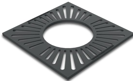
Griglia salva alberi realizzata in ghisa trattata con primer e verniciata a forno. Composta da due pezzi. Colorazione: Grigio Micaceo. Articolo versione **TIPO B** (FILO PAVIMENTO) munito di attacchi in acciaio zincato per l'ancoraggio da interrare. L'articolo viene fornito in **kit di montaggio**.
