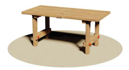
Certificato in conformità delle Norme Europee EN 1176 dall'Istituto Tedesco TÜV - SÜD. Realizzato in legno di pino nordico impregnato in autoclave con sali atossici. L'intelaiatura è costituita da fasce sez. cm 7x4,5 e traverse di rinforzo sez. cm 7x7. Il piano del tavolo è realizzato con fasce di sez. cm 9x3,5. Assemblaggio mediante bulloneria in acciaio zincato 8.8 e dadi autobloccanti. Elementi copridado a norma in nylon colorato.
