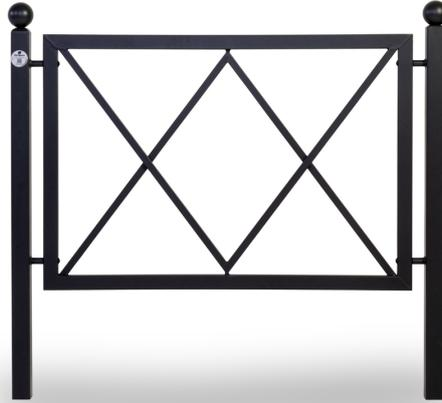
Transenna parapedonale costituita da n° 2 paletti in tubolare di acciaio zincato sez. mm 50x50 e altezza cm 120 da interrare completi di sfera copritubo ornamentale, pannello centrale realizzato in tubolare di acciaio zincato sez. mm 40x20 e profili ornamentali in tubolare di acciaio zincato sez. mm 20x10. Verniciatura a forno a 180° C. Fornito al Cliente in kit di montaggio con bulloneria in acciaio zincata. Predisposto per l'ancoraggio nel terreno.
