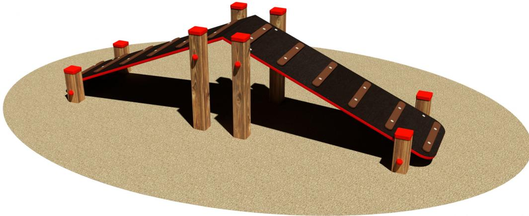
Realizzato in legno di pino nordico impregnato in autoclave con sali atossici. Costituita da n° 2 pedane inclinate in multistrato di betulla ad incollaggio fenolico, con zigrinatura antiscivolo, e rifinitura con film colorati in entrambi i lati, sorrette da n° 4 montanti in legno di pino lamellare della sez. cm 7 x 7. Assemblaggio mediante bulloneria in acciaio zincato 8.8 e dadi autobloccanti. Elementi copridado a norma in nylon colorato. Tappi copripalo in polietilene.
