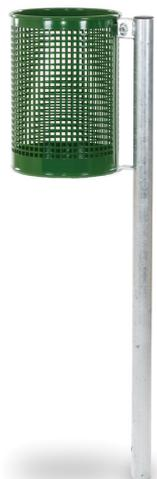
Cestino portarifiuti stradale Ecoluxe. Realizzato con paletto di sostegno in tubo tondo di acciaio zincato a caldo Ø 50 mm e altezza cm 120 da interrare. Cestino di forma cilindrica in lamiera di acciaio con fori quadri, interamente zincato e verniciato a forno a 180° C. Sganciamento del cestino con chiave a brugola fornita in dotazione. Colorazione: Verde Ral 6029
