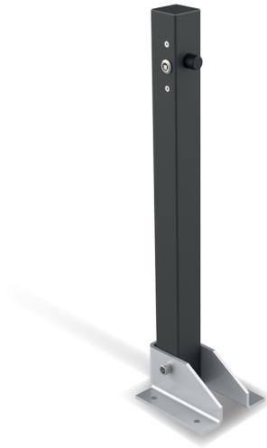
Modulo abbattibile realizzato in tubo di acciaio sez. cm 7x7 verniciato a forno, completo di base in lamiera di acciaio zincato a caldo dim. cm 19x20. Sistema di sblocco con chiavetta fornita in dotazione.
